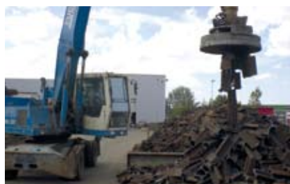
Bagger mit Magnetplatte trennt Eisen von NE-Metallen
