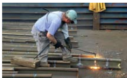
Metallarbeiter mit Schneidbrenner
