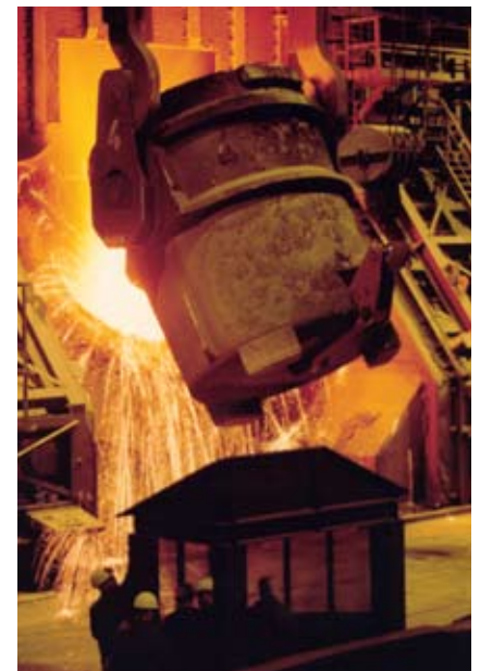
Im Konverter wird aus Roheisen Stahl.
